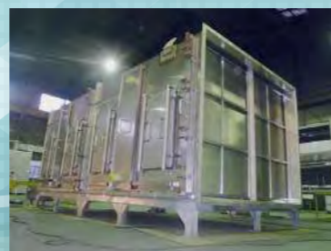
オールSUS蒸気フィルター式試験装置
