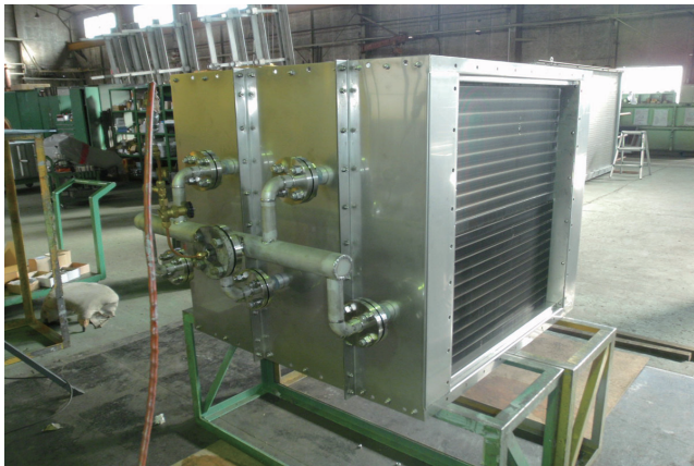
蒸気コイル・全ステンレス製
