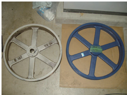
交換前後のプーリー
