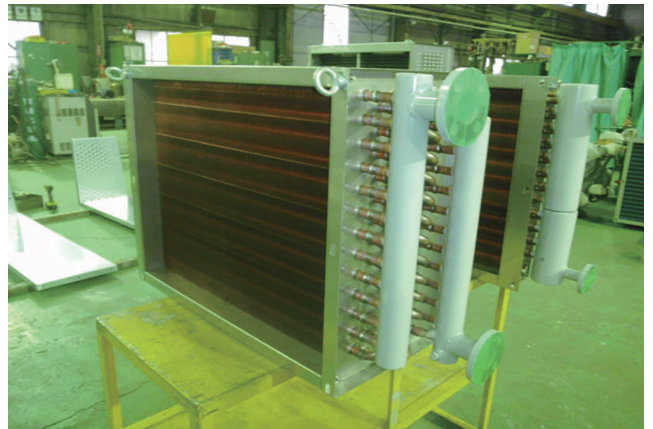
冷温水コイル・銅管・銅フィン
