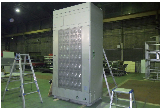
サーバールーム冷却用
