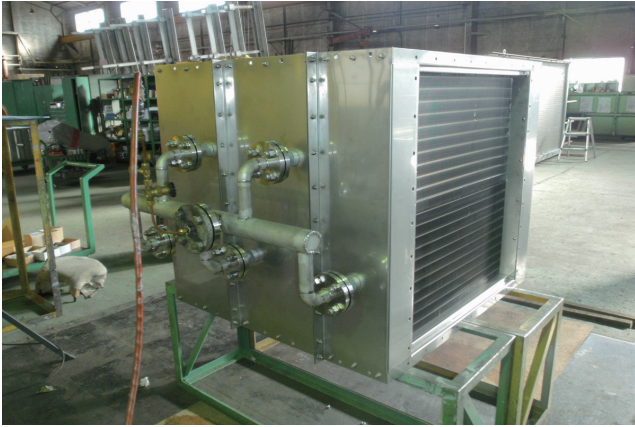
蒸気コイル・全ステンレス製
